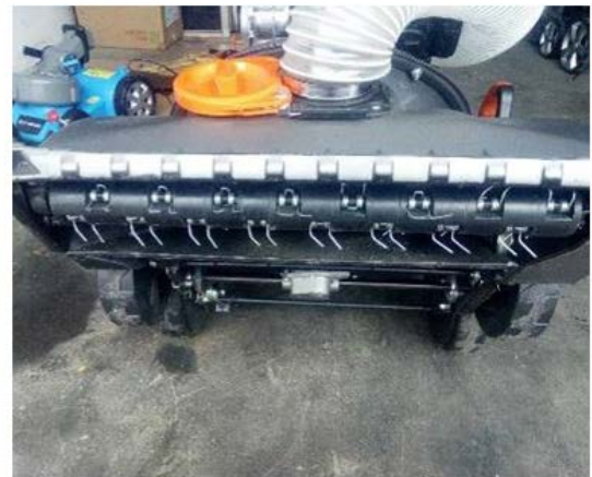
Rys. F-6 Zamontowana szczotka
